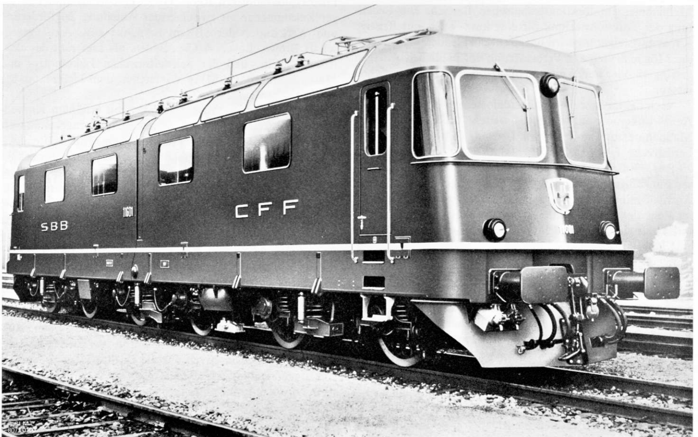
1 Lokomotive Re6/6 11601 mit geteiltem Kasten.
