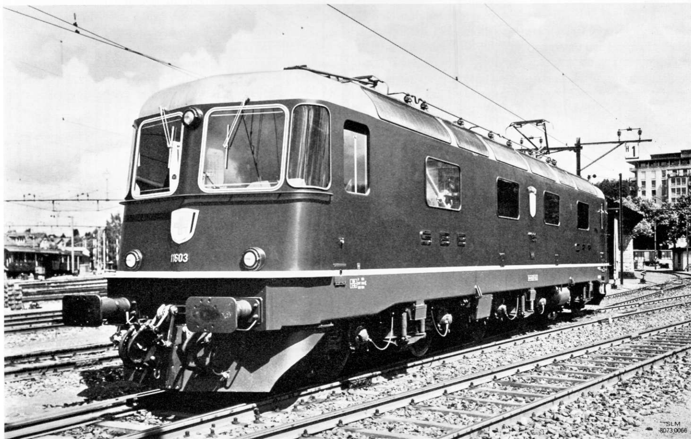
2 Lokomotive Re6/6 11603 mit einteiligem Kasten.
